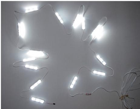
Segmente einer LED-Beleuchtung zum Selbstbau
